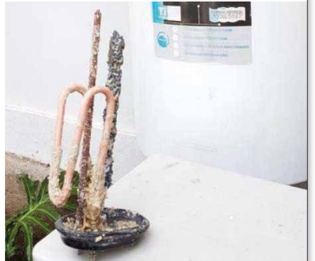
Kalan az miktarda kireç yumuş halde ve Vulcan Kireç Önleyici Sisteminin kurulmasından sonra kolayca temizlenebilir durumda.
